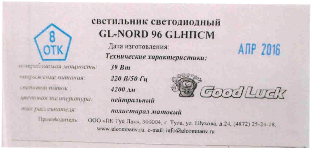
Фотография 1. Светодиодный светильник GL-NORD 96 GLНПСМ, зав.№ б/н (усл.№ 16-086).
